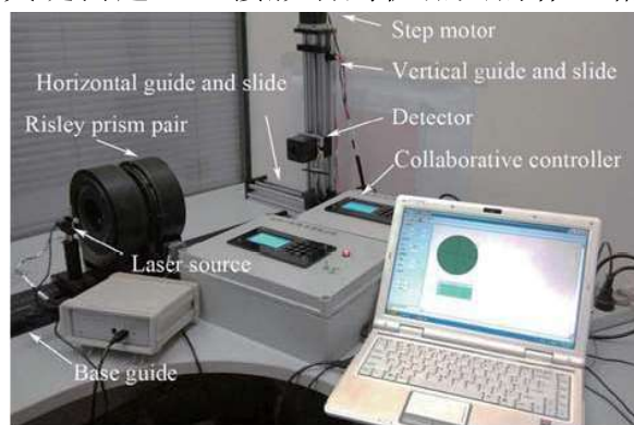
激光多模式跟踪机器人轨迹误差测量系统实验
