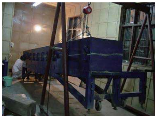
图 3、锁模、抽真空、注树脂、挤胶
