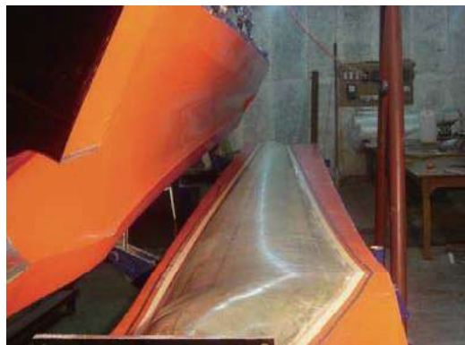
图 4、固化、退去智能芯、开模
