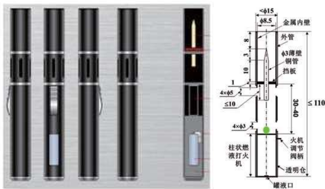
图 2-1 不燃烟加热器产品及结构图
