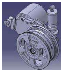
图 1. 一体化单摆臂悬架 - 减速式轮边独立电驱动桥
