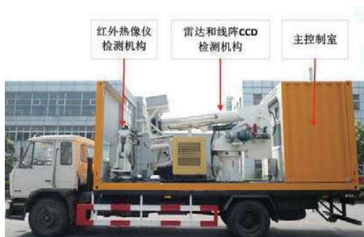
图2 隧道病害集成检测车内部组成
