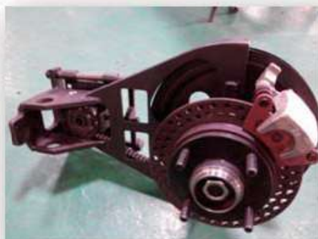
单摆臂悬架-轮毂同步带传动总成样机
