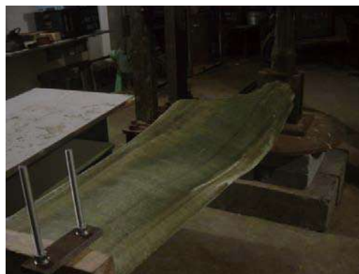
图 7、极限载荷下叶片局部失稳破坏
