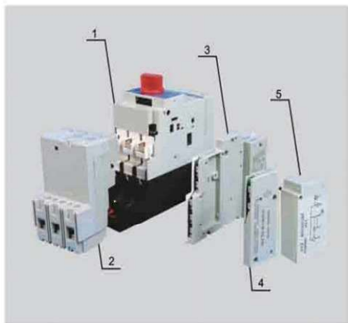
1.主体 2.热磁脱扣器 3.辅助触头模块 4.分励脱扣器 5.远距离再扣器
