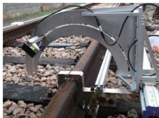
三维测量钢轨横纵轮廓的专利示意图
