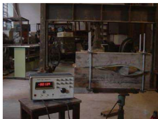
图 6、压力传感器记录静加载
