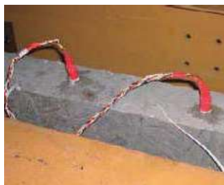
图 3 埋入式数字式测量混凝土内部相对湿度的照片
